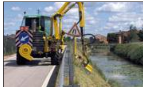
I Boscaro nel Padovano per la manutenzione di canali e cigli stradali si affidano tra l'altro a un decespuigliatore semovente .
